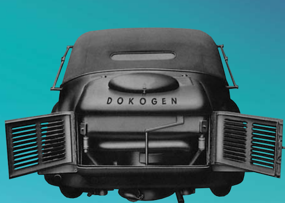
Шкода Суперба образца 1942 года с генератором на «древобгаз» ДОКОГЕН.
