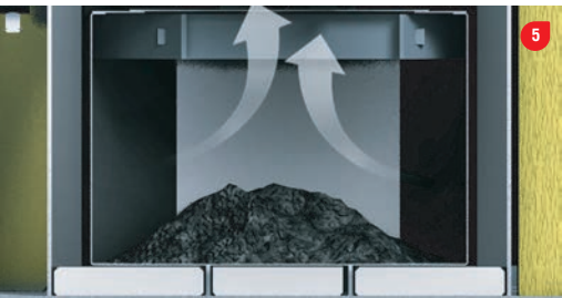
Великий золовий ящик дозволяє проводити його очищення, всього 1 раз на тиждень, навіть за умови використання «дешевої» пелети.
